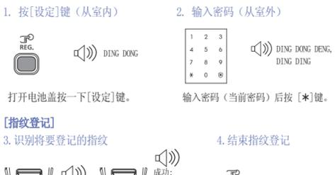
指示灯亮时用将要登记的指纹接触指纹识别器。听到“叮”的声音, 待指示灯灭后收回手指。(反复识别三次)
