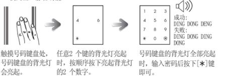
触摸号码键盘处, 任意2个键的背光灯亮起时, 按顺序按下亮起背光灯的2个数字。号码键盘的背光灯全部亮起时, 输入密码后按下[\*]键即可。
