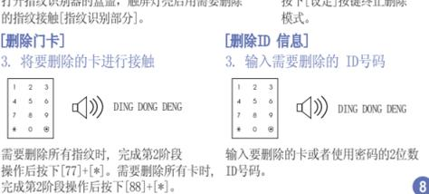
需要删除所有指纹时, 完成第2阶段操作后按下[77]+[\*]。需要删除所有卡时, 完成第2阶段操作后按下[88]+[\*]。
