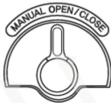
向左或向右拨动手动开关装置可锁门或解除锁门状态
